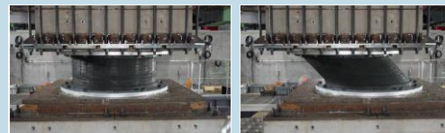
設置予定の免震部材 (天然ゴム系積層ゴム支承) での試験の様子
